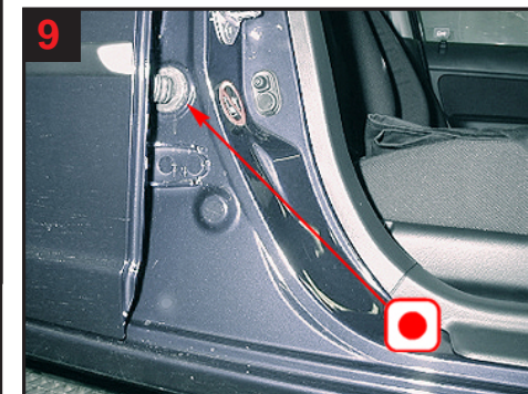
9 B-pillar. Inject via grommet.
